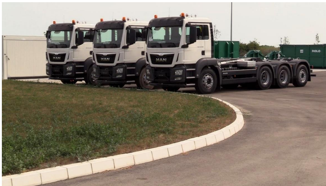
Слика бр. 4: Возила са телескопском руком за превоз роло контејнера
